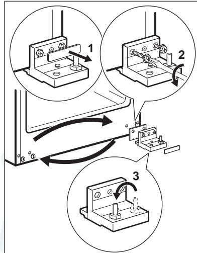
11. Установите скобу средней петли на противоположной стороне прибора.
