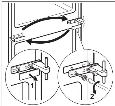
9. Снимите крышку и заглушки нижней петли, а затем отвинтите скобу нижней петли.
